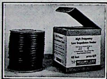
Nieuwe B-L voedingslijn voor uit het midden gevoede zend- en ontvangantennes. Karakteristieke impedantie bij 45 mHz 80 ohm — verlies in db per 30 meter bij 45 mHz 1.1 en bij 14 mHz 0.6.
